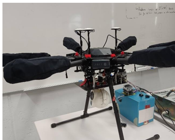
Figura 4 - UAV de asa móvel equipado com sistema computacional de bordo e sensor ótico do espectro visível e infravermelho.
